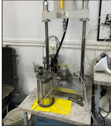
Figura 19: Ensayo Triaxial [elaboración propia]
