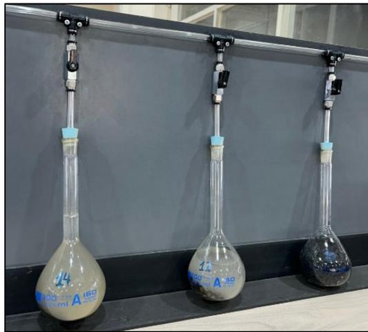
**Figura 17:** Ensayo de gravedad específica [elaboración propia]
