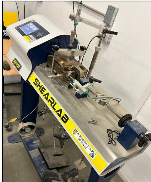
Figura 18: Ensayo de Corte Directo [elaboración propia]
