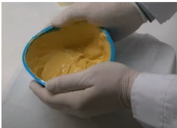
Vibrar el yeso y eliminar las burbujas de la superficie del material
