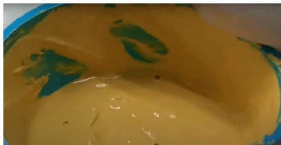
Vibrar el yeso y eliminar las burbujas de la superficie del material
