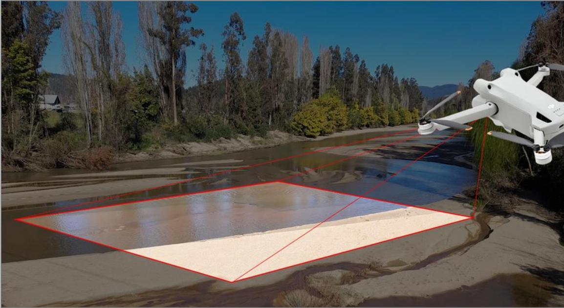
Figura 34: Representación ilustrativa de un campo de visión de una cámara de UAV.
