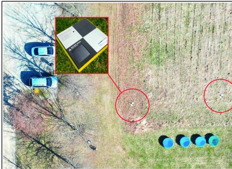
Figura 35: Implementación de GCPs para tomas aéreas con UAV. Extraído desde Cromwell et al. (2021).
