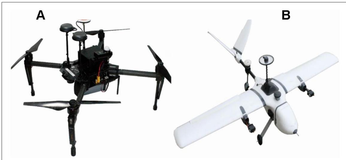
*Figura 5: Ejemplos de UAVs de ala rotativa (A) y ala rígida (B). Extraído desde Archarya et al. (2021).*
