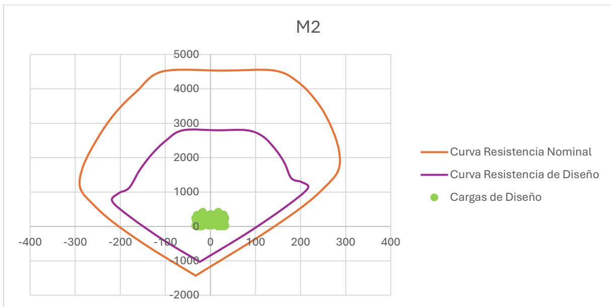
Figura 28: "Diagrama de Interacción de Muro 3 con respecto al eje X del Modelo 2".
