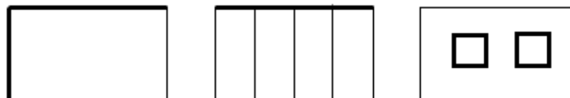
Figura 4.4: Formas de disposición de los muros en planta con regular rigidez torsional. (Fuente: Letelier 2003).
