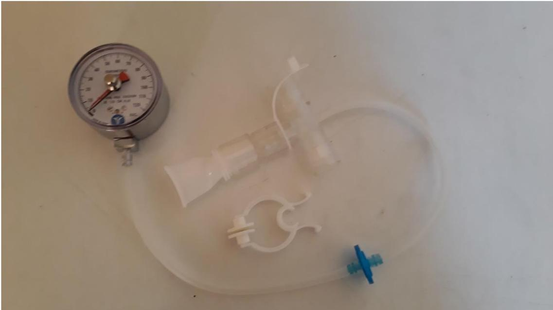
Anexo N°4. Imagen de válvula threshold utilizada.
