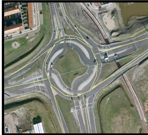
Figura 2.8 Turbo Glorieta tipo en Rotterdam, Holanda (Barbosa, 2014)
