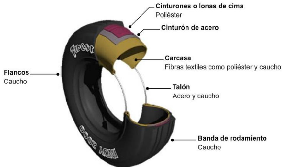
Figura 2.4: Estructura de un Neumático (Fuente: Tirel, 2017)
