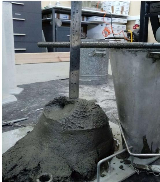
Imagen 3.1. Cálculo de asentamiento mediante ensayo de cono de Abrams. (Fuente: Elaboración propia)
