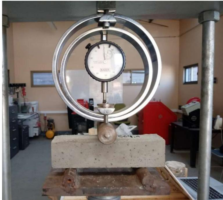
Imagen 1.2 Ensayo de Flexión, gata hidráulica manual 25 kN. (Fuente: Elaboración Propia)
