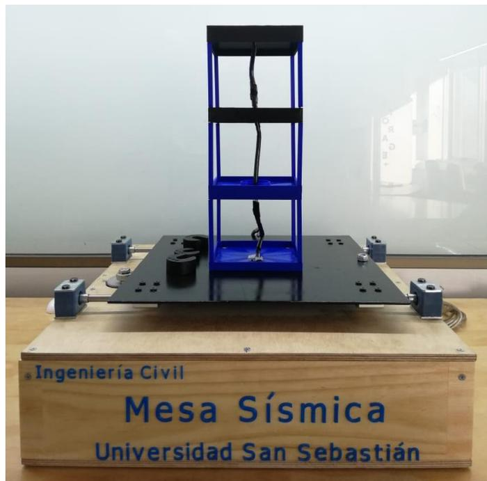
*Ilustración 4.18:* Simulador sísmico real (Fuente: Elaboración propia).
