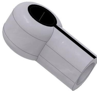
*Ilustración 4.5:* Rodamiento tipo rotula (Fuente: Elaboración propia).
