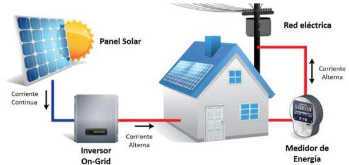
Figura 4.1 Sistema fotovoltaico conectado a la red (Hacesol, s. f.).
