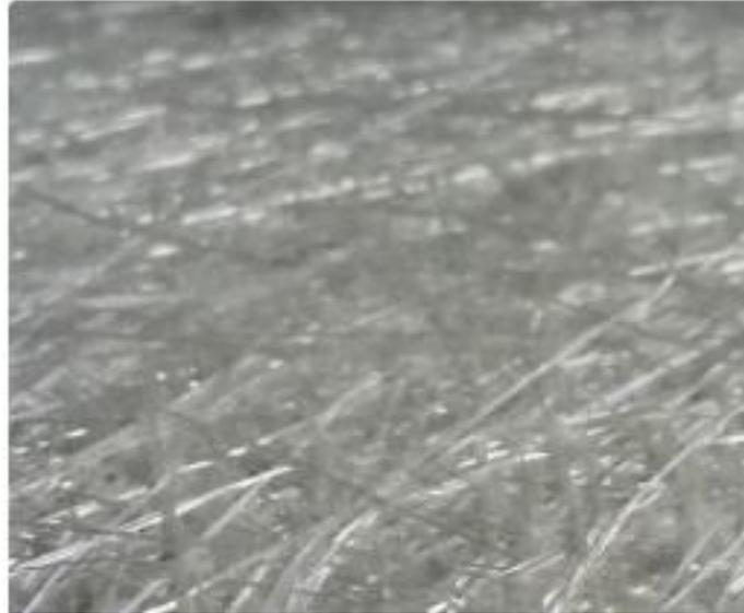
Figura 2.2 Fibras de vidrio. (Fuente: *Agy holding corp., s-2 glass fiber, 2004*).
