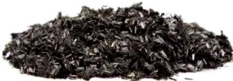
Figura 2.1 Fibras de carbono. (Fuente: *Hexcel corporation*, catálogo fibra de carbono, 2018).
