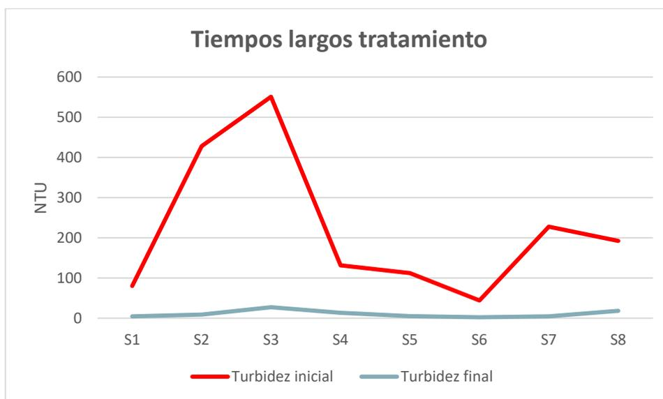
Tal como se observa en la Figura N°11, las muestras provenientes del matraz “control estático”, que contenía agua estancada sin tratamiento, presentan una alta turbidez durante las 8 semanas del experimento, mayor a la turbidez de las aguas tratadas con el biofiltro Yaku al día 4 (D4), cuyos valores son más cercanos a 0 NTU. Al normalizar los datos utilizando el porcentaje de remoción de contaminantes
