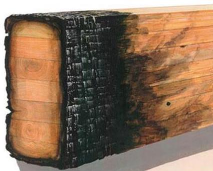
*Figura 2.3: CLT expuesto al fuego (Fuente: Madera21)*
