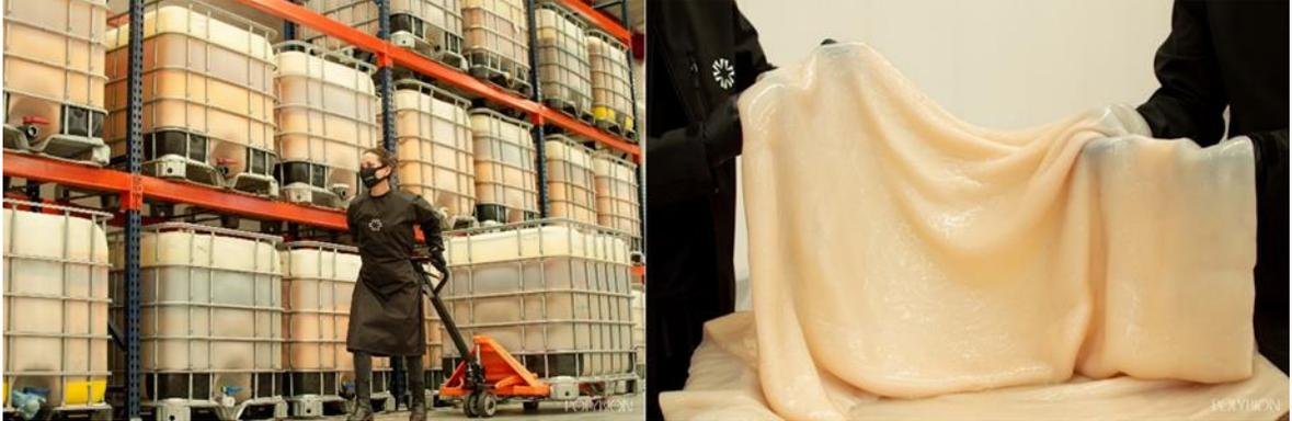
**Figura 2.** Producción industrial de CB mediante fermentación estática (Polybion™, 2022).
